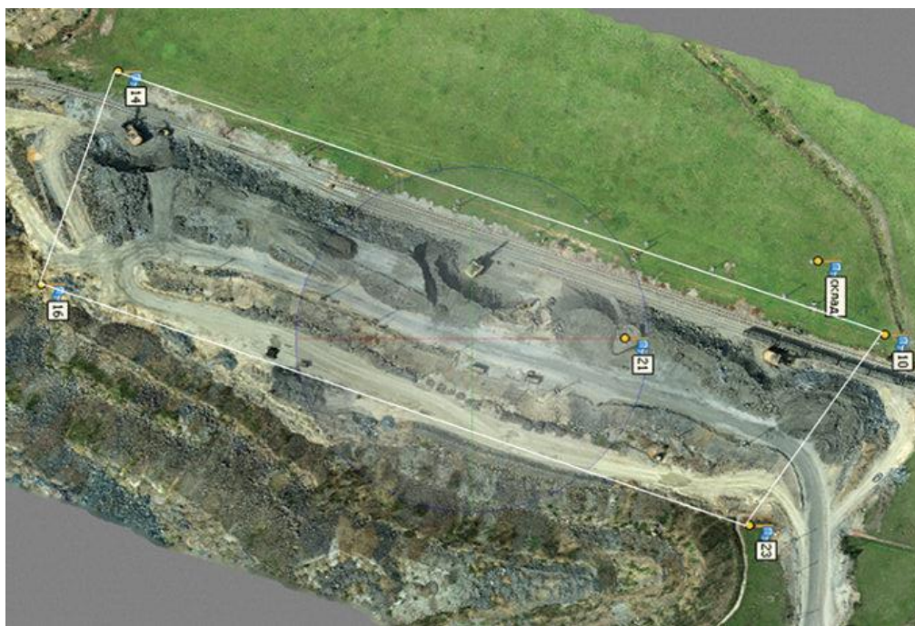
Рисунок 2.16 – Расположение опознаков и базовой станции (базы): 10, 14, 16, 21, 23 – опознаки; склад – месторасположение базовой станции
