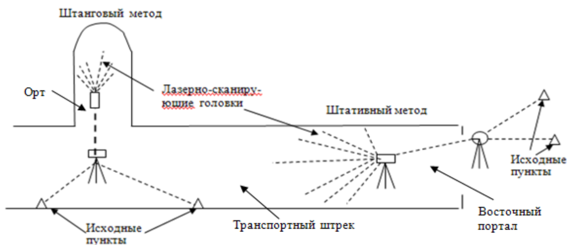
Рисунок 3.1 – Методы привязки сканирующей головки к координатной сетке рудника
