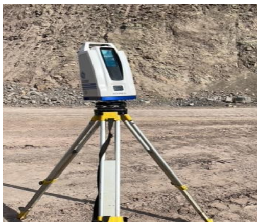
Рисунок 1.7 – Используемые приборы при проведении анализа а) Сканер STONEX 300; б) Промышленная полетная платформа MATRICE 300 RTK
