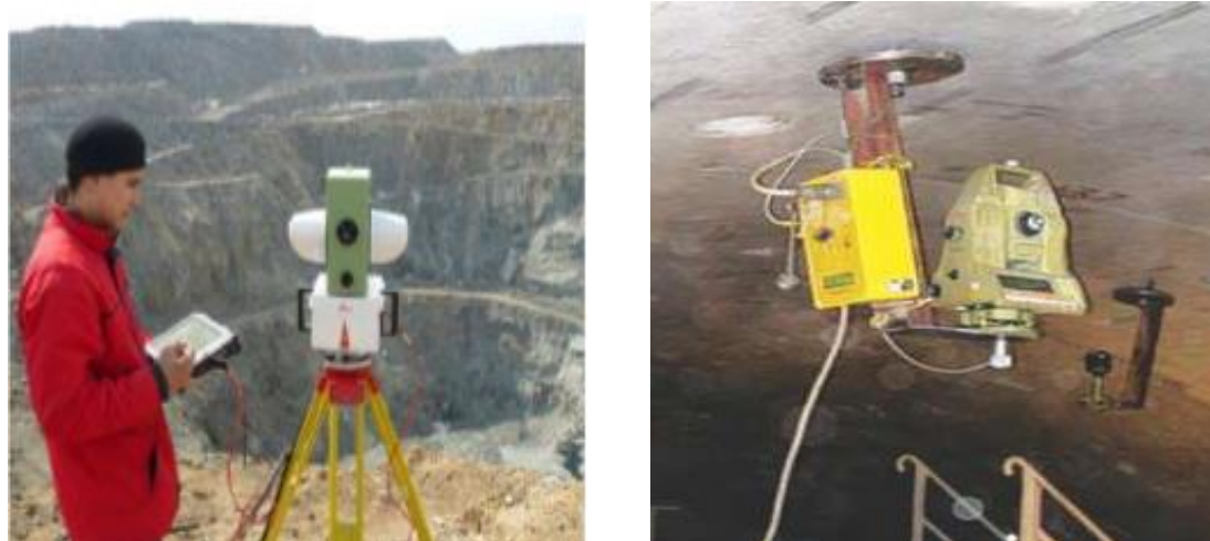
Рисунок 1.4 – Наземный лазерный сканер Callidus 3D Laser Scanner
