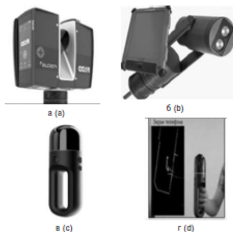
Рис. 2. Виды 3D-лазерных сканеров: а - Faro Focus 3D; б - сканер MINEi; в - 3D-сканер 6DOF; г - процесс съемки Fig. 2. Types of 3D laser scanners: a - Faro Focus 3D; b - MINI scanner; c - 6DOF 3D scanner; d - shooting process
