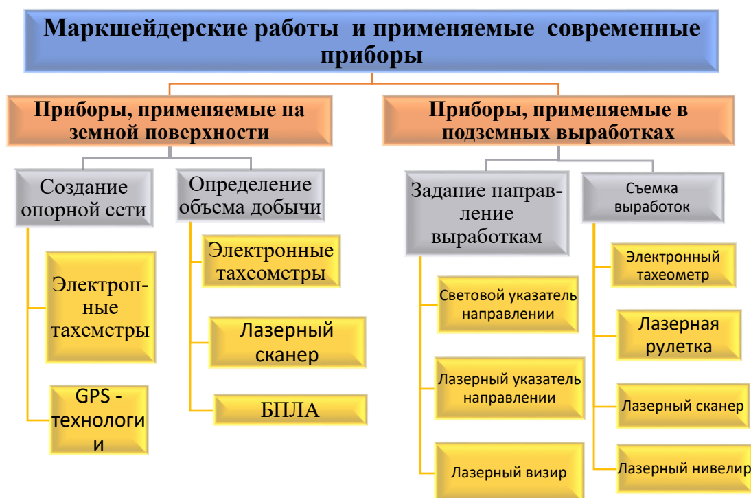
Рисунок 1.12 – Состав маркшейдерских работ и применяемые при этом современные приборы
